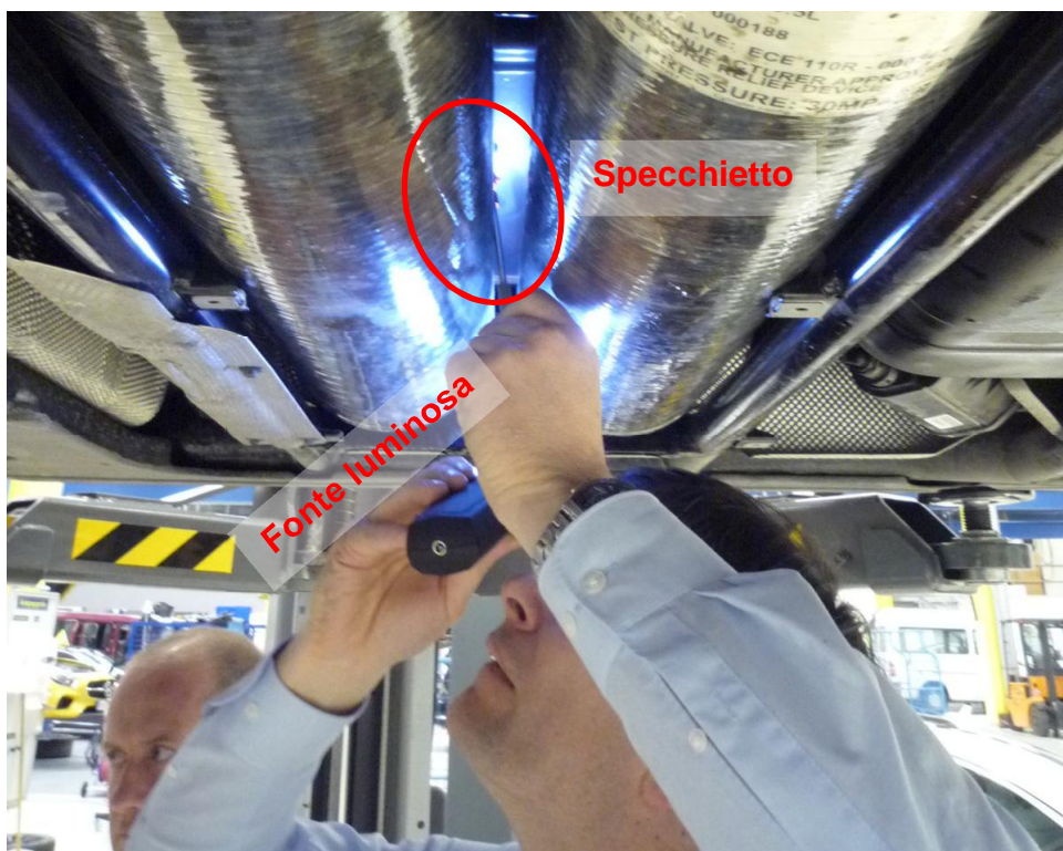
Figura 7: mediante uno specchietto e una lampada portatile, il meccanico ispeziona le zone nascoste della bombola
