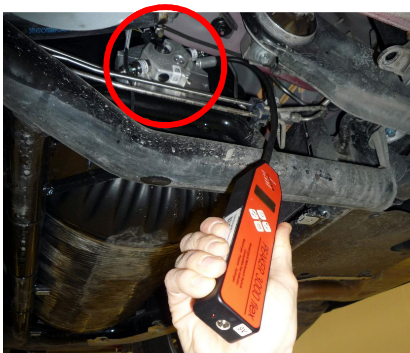
Figura 11: esempio di prova di tenuta di una valvola di bombola
