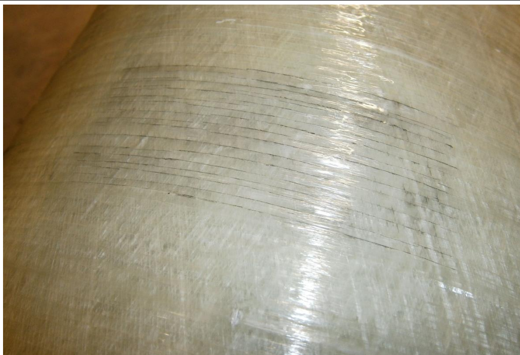
Microincrinature parallele nello strato epossidico
