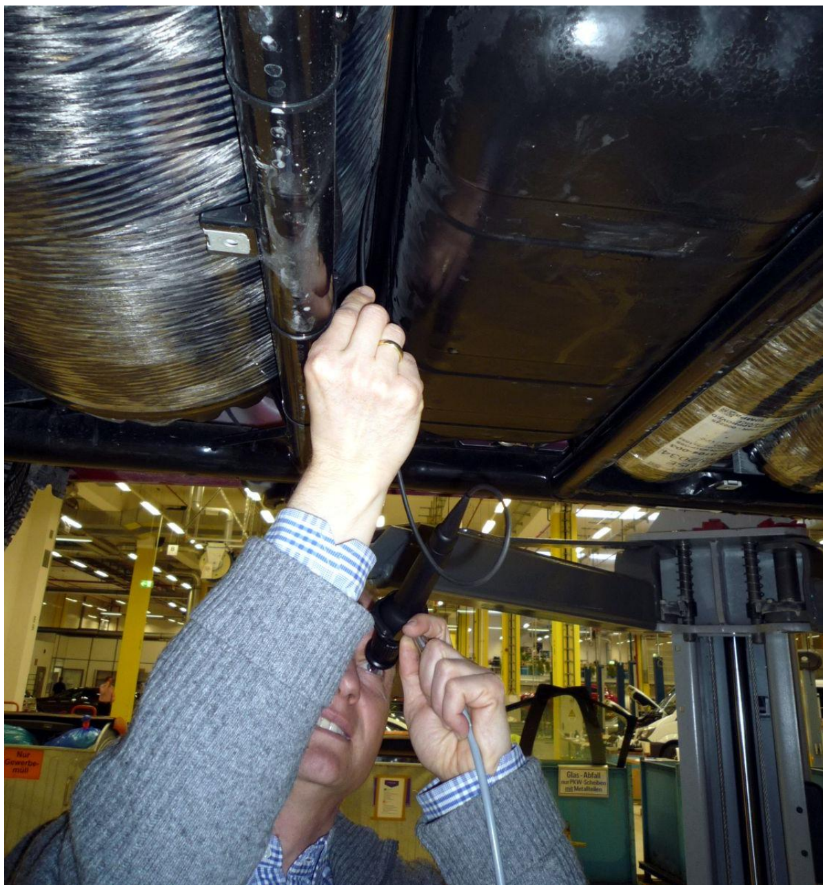
Figura 9: mediante un endoscopio, il meccanico ispeziona le zone non visibili
