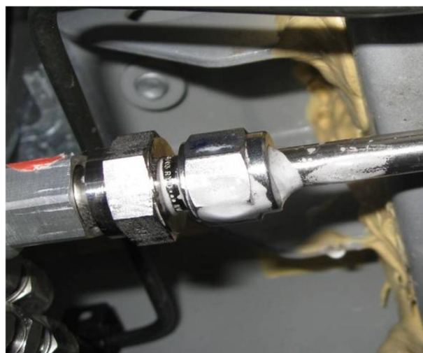
Figura 13: collegamento a vite non a tenuta, formazione di uno strato di schiuma dopo 3 min
