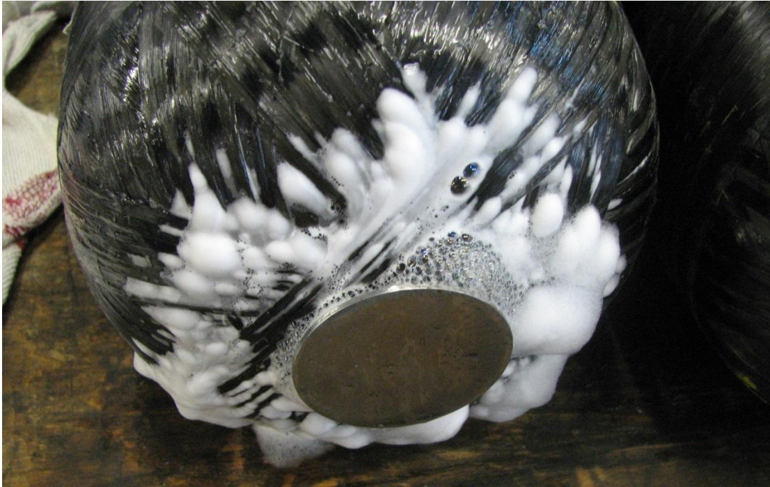
Figura 14: perdita di un cilindro a gas
